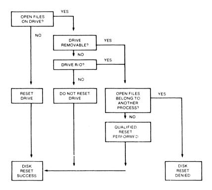
Figure 2-8. Disk System Reset
